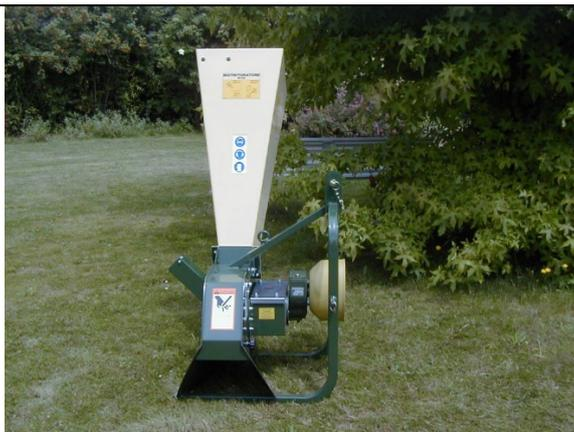
Les modèles de cette série ont une grande trémie centrale pour déchets verts tels que feuilles et coupures. Latéralement il y a une entrée pour branches à diamètre de maximum 6,5 cm.
