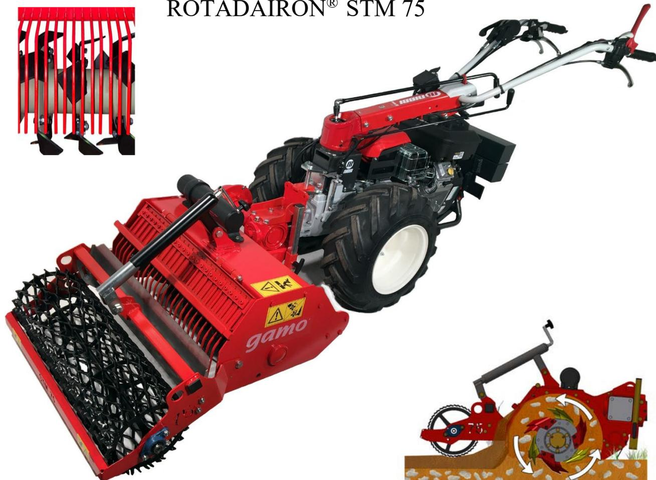
Ce préparateur de sols et enfouisseur de pierres convient pour enfouir pierres, débris, herbes. En même temps le sol est nivelé et compacté par le rouleau tramé. On obtient ainsi une couche supérieure fine et nivelée qui convient, par exemple, à l'ensemencement du gazon.
