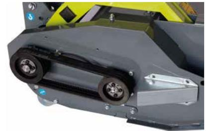
3 courroies trapézoïdales
