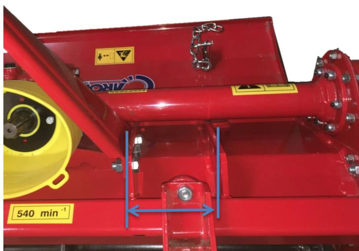
Le 3<sup>me</sup> point et les attaches réglables sont centrés sur l'axe du tracteur mais un décentrage vers la droite de 16 cm est possible sur les modèles FL1100-1200-1300 et 1400 et sur tous les modèles FM.
