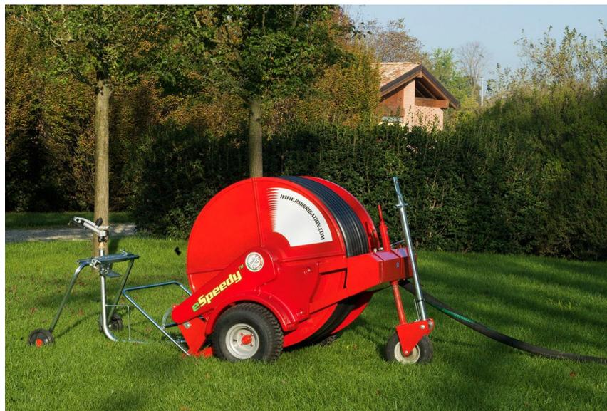
La eSpeedy Rain est une évolution dans laquelle l'enroulement se fait électriquement via une batterie rechargeable. La vitesse d'enroulement est contrôlée électroniquement
