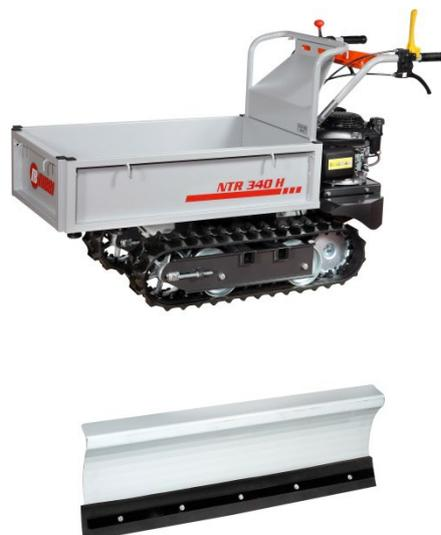
Le NTR 340 est un transporteur pour utilisation autour de la maison. Ce modèle de dumper possède une benne basculante, idéal pour le transport de bois, fruits, blocs, sable et autres matériaux de construction. Le bac peut incliner jusqu'à 45°.
