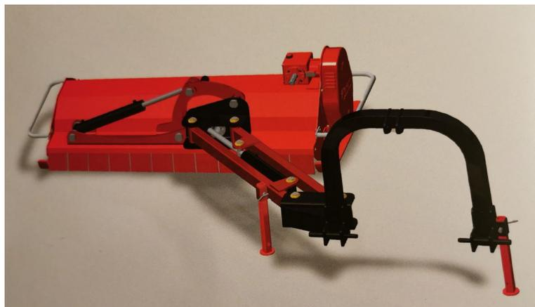
Caroni a également lancé une tondeuse à fléaux latérale. Deux types de lames sont disponibles, les lames plates de type P pour une coupe parfaite et les fléaux de type B pour les sous-bois, les champs, les bordures des autoroutes, les tiges
