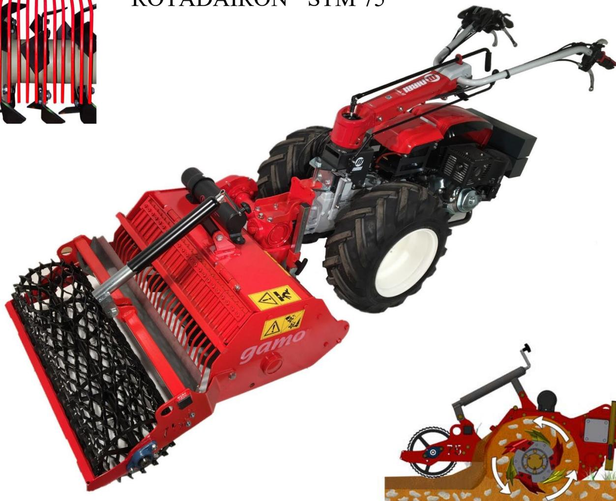
Ce préparateur de sols et enfouisseur de pierres convient pour enfouir pierres, débris, herbes. En même temps le sol est nivelé et compacté par le rouleau tramé. On obtient ainsi une couche supérieure fine et nivelée qui convient, par exemple, à l'ensemencement du gazon.
