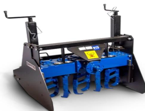
La déssherbeuse Gamo est la solution idéale pour déssherber et égaliser les terrains. Une très faible profondeur de travail est possible par le réglage continu des rotors. De cette façon la structure de la couche sous-jacente reste intacte.
