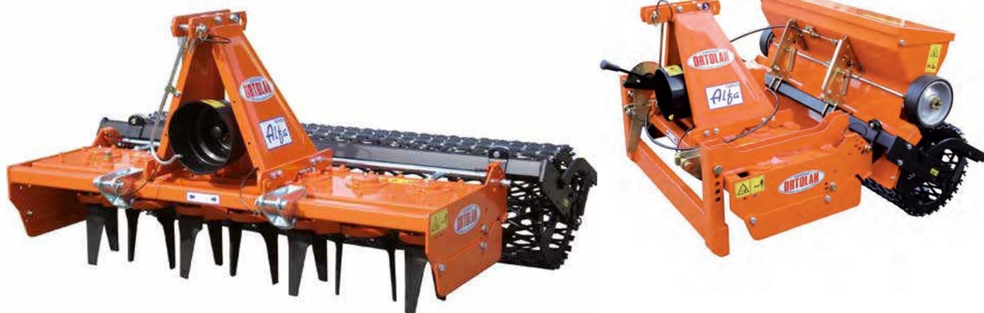
La herse rotative Ortolan est la machine idéale pour niveler, préparer et ensemer le terrain lors de la création d'espaces verts. Le sol déjà travaillé est nivelé et préparé pour le semis. Construction très robuste, dents avec profil de couteau, adaptées aux travaux les plus lourds. Avec le kit de semis en option, vous pouvez semer en une seule fois et ratisser la graine à la bonne profondeur, le rouleau grille presse bien le tout.
