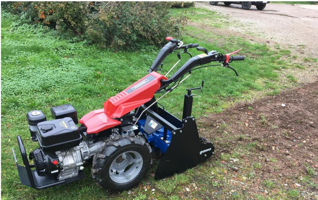
Le désherbeuse automoteur de Gamo est la solution idéale pour désherber et niveler les surfaces semi-pavées telles que les coquillages, la dolomite, le gravier ou le sable et les chemins forestiers. Une minime profondeur de travail est possible grâce au réglage en continu des rotors. En conséquence, aucun changement de structure ne se produit dans la couche sous-jacente.
