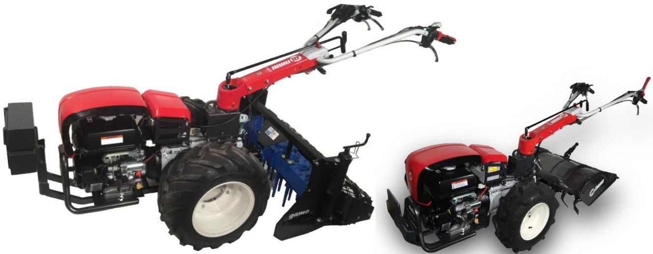
Le MAK 17SL est une machine professionnelle, qui peut être utilisée à bien d'autres fins grâce au guidon réversible et à l'inverseur. Pensez à une herse rotative, une désherbeuse, une bêche rotative et tous les outils frontaux tels que barre de coupe, brosse, etc. La machine est équipée d'un moteur à essence.
